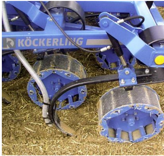
Slika 90. Ulagačka sekcija agregata serija Ultima, Köckerling [53]
