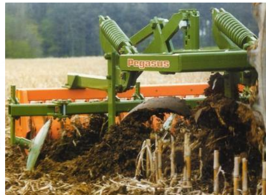
Slika 29. Nošeno rovilo s motičicama oblika ”pačja noga”, osiguranjem od oštećenja opstrukcijama, te četiri tanjura promjera 46 cm i dvostrukim cjevastim valjkom (lijevo) i u radu (desno), Amazone [46]
