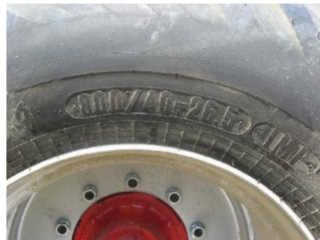
Slika 60. Vozni kotač sijačice, jednoreadni gumeni valjak Ø 65 cm, dvostruki diskosni ulagači Ø 32 cm, nagazni kotači i elastični prsti (lijevo) i dimenzije vozne gume (800/40-26,5) pneumatske sijačice Horsch (desno), Horsch [51]
