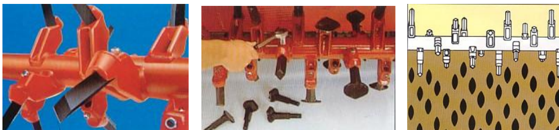
Slika 39. Klin (30 x 30 mm) duljine i zamjena serijskih klinastih zubi sa specijalnim mulč zupcima, izgled tla obrađenog klinovima, RAU [61]
