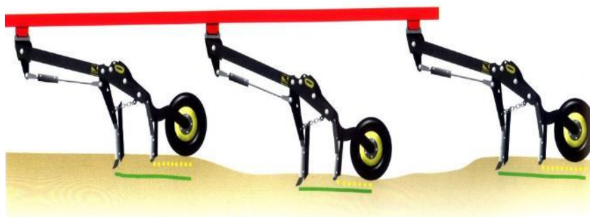
Slika 83. Prilagodba sijačnih jedinica agregata Seed Hawk mikroreljefu, Väderstad [64]
