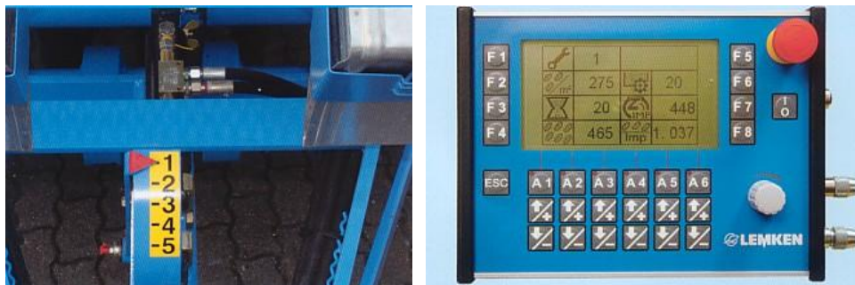
Slika 76. Hidrauličko podešavanje i pokazivač radne dubine tanjura (lijevo) i Solitronic PRO za upravljanje i nadziranje rada stroja, Lemken [56]
