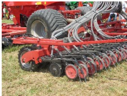
Slika 60. Vozni kotač sijačice, jednoreadni gumeni valjak Ø 65 cm, dvostruki diskosni ulagači Ø 32 cm, nagazni kotači i elastični prsti (lijevo) i dimenzije vozne gume (800/40-26,5) pneumatske sijačice Horsch (desno), Horsch [51]
