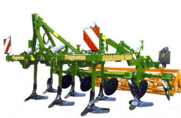
Slika 29. Nošeno rovilo s motičicama oblika ”pačja noga”, osiguranjem od oštećenja opstrukcijama, te četiri tanjura promjera 46 cm i dvostrukim cjevastim valjkom (lijevo) i u radu (desno), Amazone [46]
