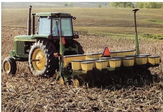
Slika 67. Sijačica s podtlakom Max Emerge 2, John Deere [52]
