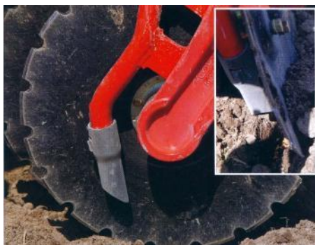
Slika 80. Nazubljeni disk - ulagač sjemena sijačice Rapid, Väderstad [64]
