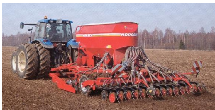
Slika 57. Dopunska obrada tla i sjetva u jednome prohodu, Horsch [51]
