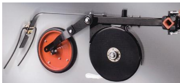
Slika 62. Dvostruki diskosni ulagač s plastičnim usmjerivačem sjemena, pritiskujućim nagaznim kotačem obloženim gumom i par elastičnih prstiju, Horsch [51]
