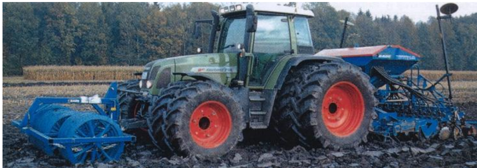
Slika 27. Dopunska obrada oranoga tla Packer valjkom i istovremena sjetva mehaničko-pneumatskom sijačicom zahvata 3 m, Rabe Agrarsystem [60]
