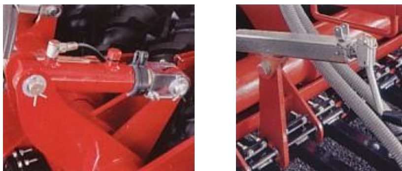
Slika 64. Centralno podešavanje dubine polaganja sjemena postavljanjem umetaka (lijevo) i pojedinačno ručicom (desno), Horsch [51]
