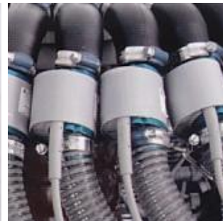
Slika 61. Pneumatska distribucija sjemena (lijevo), sijači aparat s različitim sijačim valjcima (sredina) i stalna kontrola protoka sjemena do ulagača, Horsch [51]
