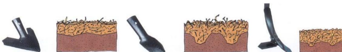
Slika 33. Oblik rala „pačja noga“ B = 22,5 - 37 cm (lijevo), kopljasto B = 7,5 cm (sredina) i dlijeto+„pačja noga“ B = 25 ili 35 cm (desno), Pegoraro [59]
