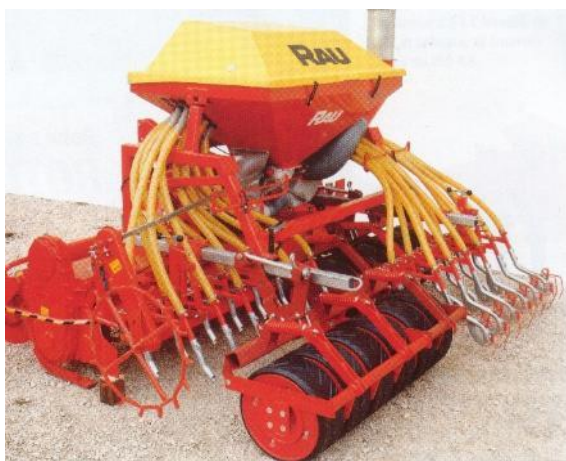
Slika 36. Kombisem sa sijačim ulagačima ispred ili iza gumenog valjka, RAU [61]
