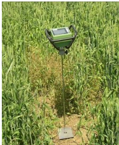
Slika 7. Elektronički penetrometar (lijevo) i grafički prikaz zbijenosti tla na displeju, Eijkelkamp [50]
