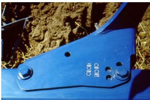
Slika 19. Podesivi radni zahvat po plužnome tijelu od 33/35; 37/40; 42/45 i 47/50 cm, Rabe [60]
