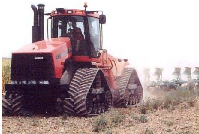
Slika 94. Traktor s gumenim gusjenicama tipa Case Steiger-Quadtrac. Širina gusjenice je 76 cm, kontaktna duljina 205 cm /gusjenici, klizanje između 4 – 6%, a specifični pritisak na tlo \leq 0,4 \text{ kg/cm}^2 [48]
