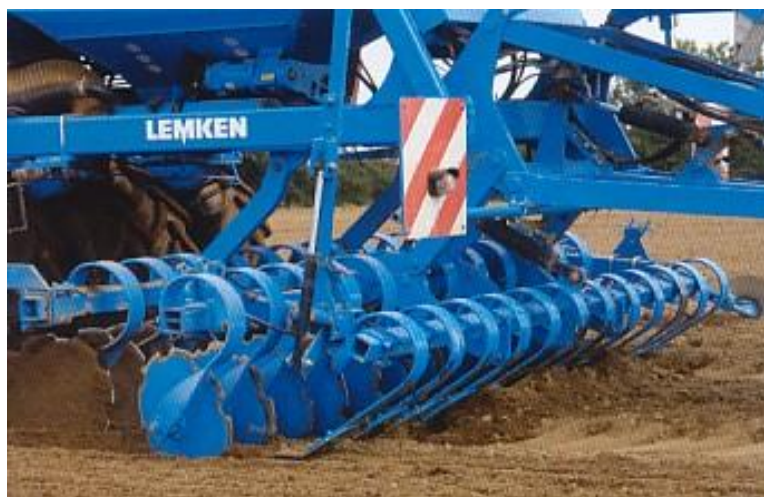
Slika 72. Hidraulički podesivi opružni prsti ravnaju i izorano tlo, Lemken [56]
