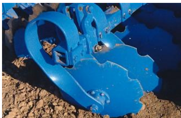
Slika 73. Plitku obradu učinkovito obavljaju dva reda nazubljenih tanjura, preko lisnate opruge priključena o okvir sijačice. Promjer tanjura je 465 mm, širine 5 mm i vertikalno su podesivi, Lemken [56]
