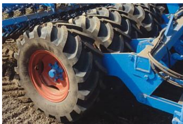
Slika 74. Ravnanje i učvršćenje-konsolidaciju obrađene površine obavlja valjak od gumenih pneumatika, Lemken [56]
