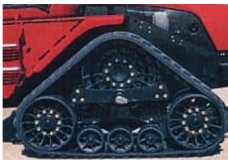
Slika 95. Gusjenica Quadtrac-a automatski se napinje i čisti [48]
