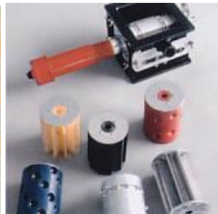
Slika 61. Pneumatska distribucija sjemena (lijevo), sijači aparat s različitim sijačim valjcima (sredina) i stalna kontrola protoka sjemena do ulagača, Horsch [51]
