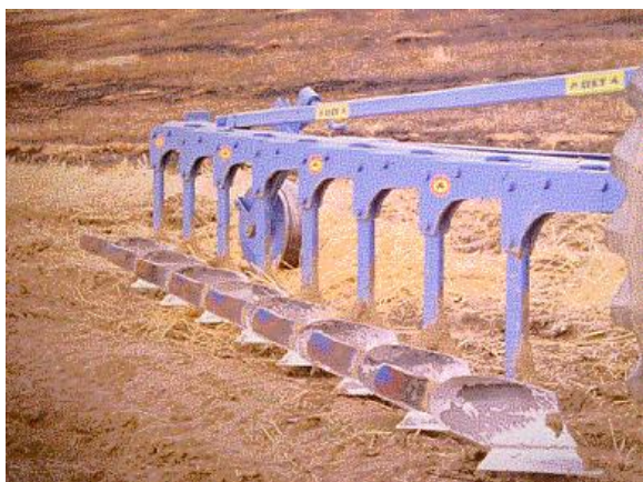
Slika 21. Nošeni plug za prašenje strništa zahvata 1,6 m OLT [57]
