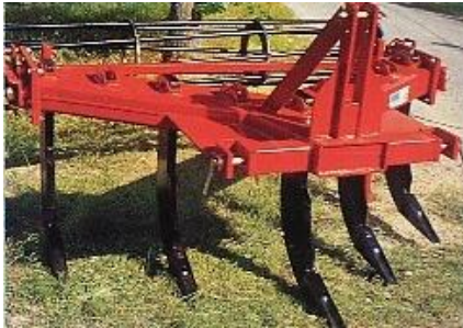
Slika 28. Nošeno rovilo s dlijetastom motičicom na krutom nosaču i cjevastim valjkom (lijevo), Kuhn [55]; Rovilo s dlijetastom motičicom na opružnom nosaču, diskovima promjera 46 cm i gumenim rednim valjkom (desno), Amazone [46]
