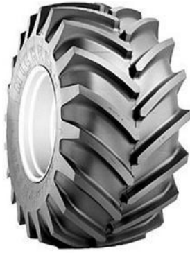
Slika 101. Široki pogonski pneumatik 710/70R42 TL 173A8/173B XM28
