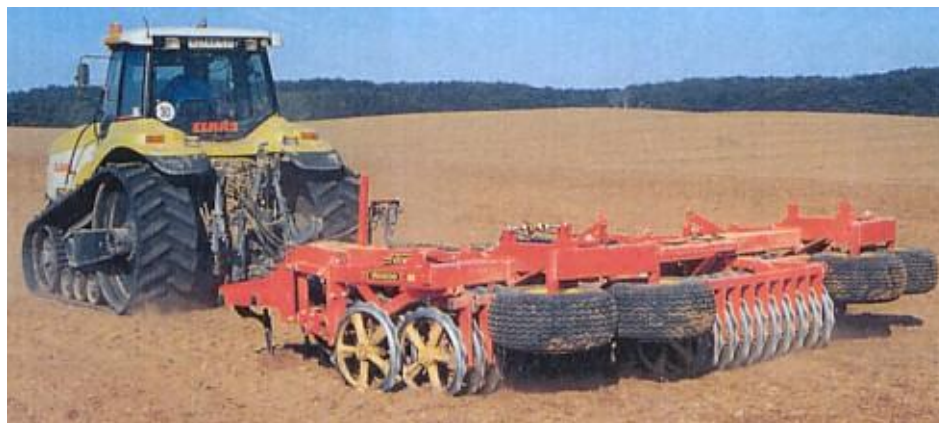
Slika 97. Traktor Challenger s oruđem Rexius-Twin u dopunskoj pripremi tla za sjetvu [45] [64]
