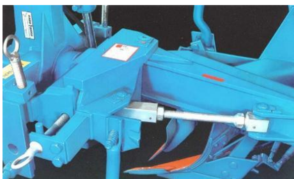
Slika 18. Mjesta podešavanja zahvata prvog plužnog tijela i usklađivanje linije vuče i linije otpora pluga na okretnom plugu Rabe [60]
