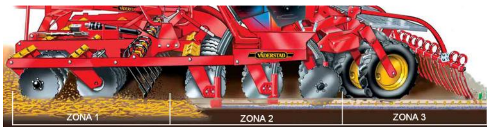
Slika 79. Radni dijelovi sijačice Rapid i njihovo djelovanje u tlu, Väderstad [64]
